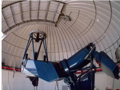
Para sacar el telescopio de límites tenemos que hacerlo desde la raqueta de ingeniería. Para activarla hay que ir a la sala de la GPS y pasar el conmutador del teclado del PC de control de la posición 'USUARIO' (que es donde debe estar para mover el telescopio desde la sala de control) a la posición 'INGENIERÍA' (que corresponde con el pupitre de la cúpula).
