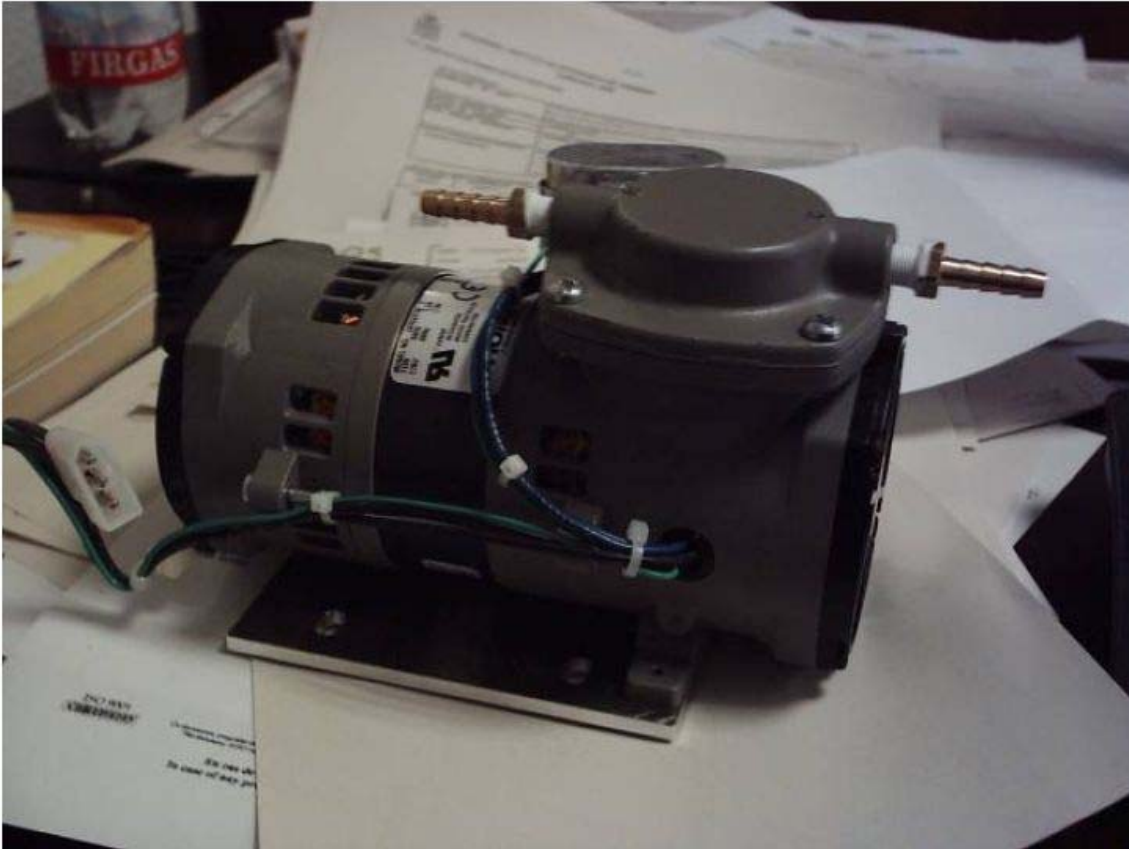
Foto 2: Detalle de la bomba de aire instalada actualmente.
