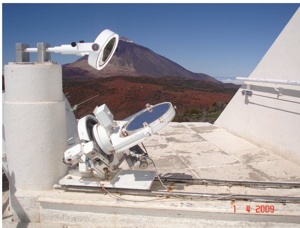
Figura 1.- Celostato del Mark-I en su configuración de “Montura de Verano”, tras el cambio realizado el 1 de abril de 2009.
