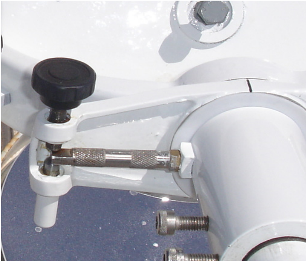
Figura 3. Detalle del Tornillo de “Ajuste Fino” (en este caso el del eje X) del espejo secundario del celostato del Mark-I en la configuración de “Montura de Verano”.
