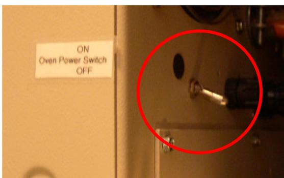
4. Accionar el interruptor del horno entre la alimentación de éste y el receptáculo de la batería de la UPS a su posición OFF (hacia abajo).
