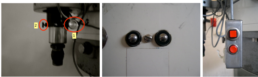
Figura 5: Foco del buscador (izda.); foco manual (centro) y automático del telescopio (dcha.).
