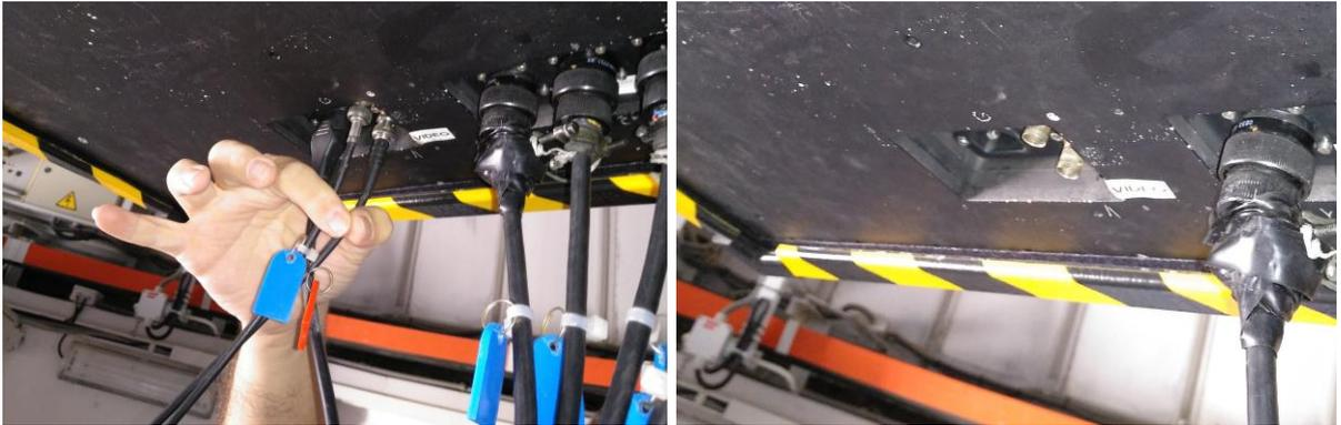
4. Desconecte los 3 conectores metálicos etiquetados como “MOTOR”, “RS422” y “SENS”.
