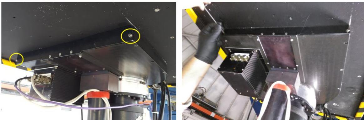
6. Con mucho cuidado, y revisando que no tropiece con ningún cable, tire suavemente de la rueda de filtros para deslizar el conjunto hasta extraerlo.
